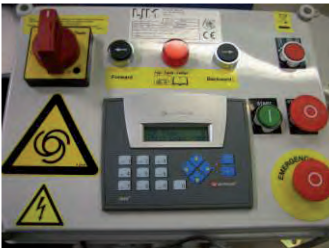
Neuer Schaltschrank mit PLC mit Anzeige Näherungsschalter an der Trommel
