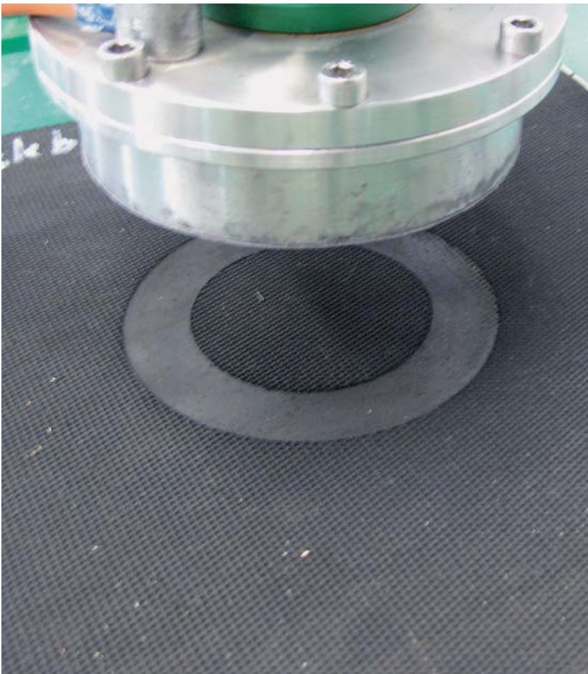
Bild 6: Testmuster nach dem Abriebtest
