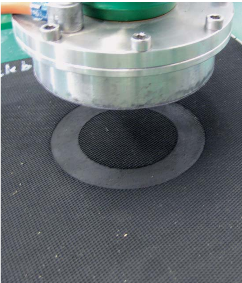
Bild 6: Testmuster nach dem Abriebtest
